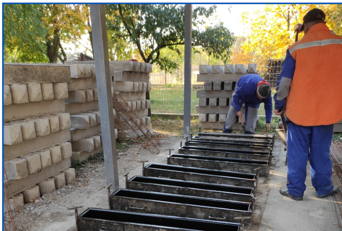
Szelvénykövek gyártása a Pocsaji védelmi központban
