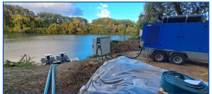
2. ábra - Úszó vízkivételi mű és áramfejlesztő aggregát
